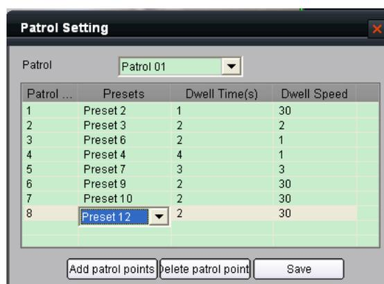
Рисунок 4.2.24 Установка маршрута патрулирования
