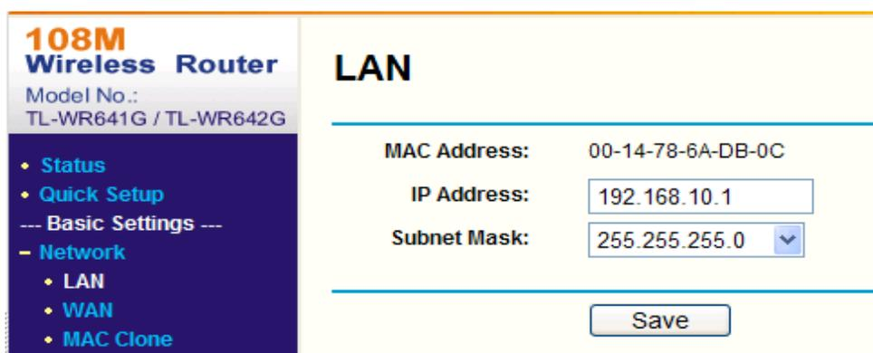
Рисунок 4.5.2 Установка параметров сети
